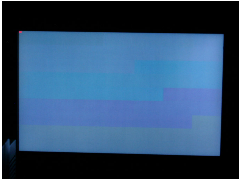
Abb. 7 Image Sticking beim Testbild mit 126 Messfeldern. Es sind folgende Effekte zu erkennen: - Schwarz (links oben) ist dunkler als die anderen monochromen Graustufen - Bei den RGB-Farbstufen (> 51) ist kein Graustufen-abhängiges Image Sticking zu erkennen, die Flächen sind homogen gefärbt
