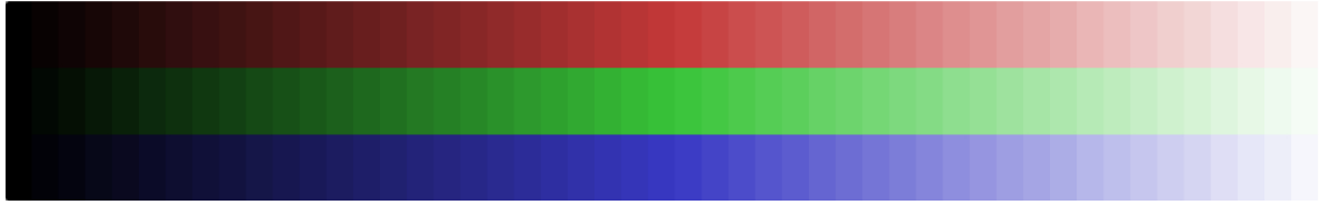
Abb. 1: Zu geringe Farbsättigung (Colour, Chromapegel) Die Qualität dieses Beispiels entspricht „mangelhaft“ ★★
