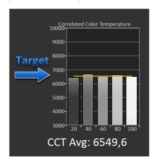
Durch die Farbtemperaturvorwahl "Warm2" hat der Sony TV schon werkseitig eine sehr gute Durchschnittsfarbtemperatur von 6549,6 K.
