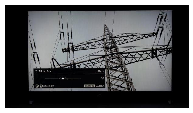
Die "Realbildsprache" bestätigt wieder die perfekte Einstellung der Schärfe mit dem Wert 50 durch die präzise Darstellung der Stromleitungen ohne störende weiße Doppelränder die die Leitungen säumen.
