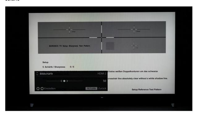
Der Parameter der Schärfe gibt werkseitig ein perfektes Bild ab. Ziel ist hier die möglichst präzise Darstellung, die weder von hellen Doppelkonturen behaftet ist noch "matschig" wirkt. Das Burosch Fadenkreuz Testbild reagiert besonders empfindlich auf diesen Parameter und bescheinigt hier einen optimalen Bildeindruck mit Schärfe 50.
