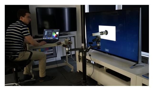
Messsystem: Die zentrale Funktion übernimmt die auf dem Laptop installierte Software CalMAN. Diese steuert den Quantum Data 4K Testbildgenerator, den Lichtsensor K-10A und wertet parallel dazu aus.
