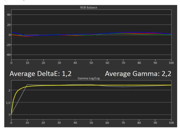
Schon werkseitig zeigt der W955B ein sehr gutes Ergebnis: Alle Graphen der RGB Balance verlaufen nahe beieinander und gut auf der Null-Linie. Lediglich im oberen Helligkeitsbereich (ca. 60 bis 100) driften die Graphen etwas nach oben ob. Das Gamma entspricht diesem Ergebnis: Es verläuft gut auf der Target Linie, der Drift im oberen Bereich zeichnet sich auch hier (gegenteilig) ab indem die Kurve sich leicht nach unten senkt.
