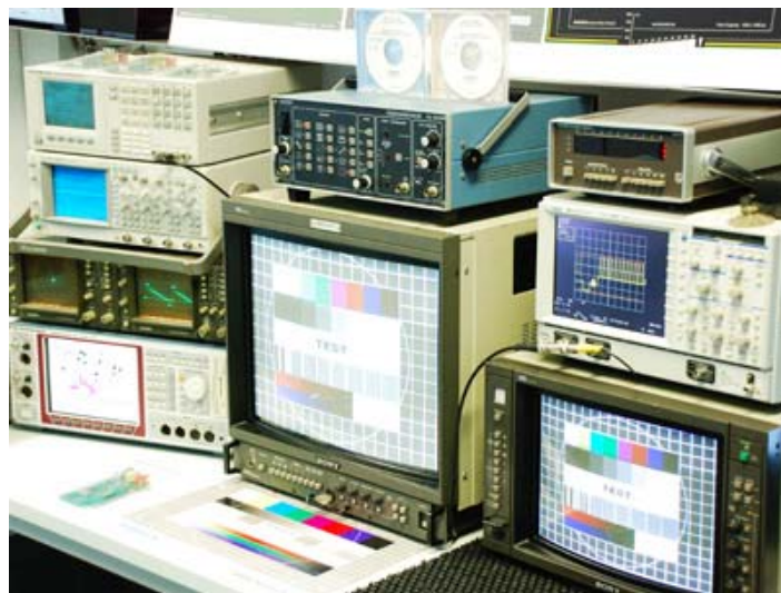
Abbildung 3: Erstklassige Mess- und Anzeigeeinstrumente von Rohde & Schwarz (VSA, UPL, CCVS), Tektronix (VM-700) und Hewlett Packard sowie mehrere Sony Broadcast Class A Monitore kommen im Labor der Firma Burosch zum Einsatz.
