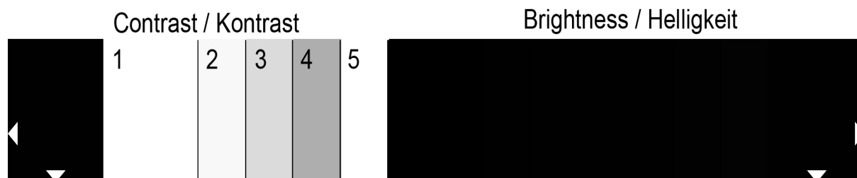
Abbildung 6.3.1 – Der untere Bildbereich des Testbilds zum Einstellen des Kontrasts. Die Balken 1 bis 5 sind für die Abbildung extra hervorgehoben (Trennlinien). Je nach Video Range sehen Sie eine ähnliche oder andere Darstellung.
