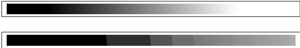
Abbildung 6.9.1 – Oben – Helligkeit und Kontrast falsch eingestellt. Clipping in den Lichtern und Schatten Unten – Extreme Quantisierungsfehler, es kommt zu Banding Effekten. Der Verlauf ist nicht mehr gleichmäßig sondern zeigt die feinen Graustufen in Treppenstufen.
