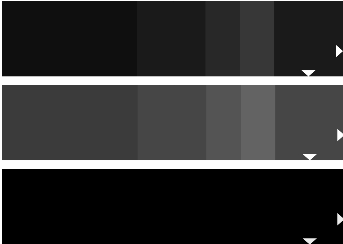
Abbildung 6.2.2.2 – Oben: Hier ist die Helligkeit für Extended Range richtig justiert. Der Balken 3 ist minimal dunkler als der Balken 4 und die restlichen Balken 5 und 6 sind etwas heller. Mitte: Die Balken unterscheiden sich zu deutlich und schwarz erscheint grau. Die Helligkeit ist zu hoch eingestellt. Unten: Die Balken unterscheiden sich nicht. Die Helligkeit ist zu gering eingestellt.
