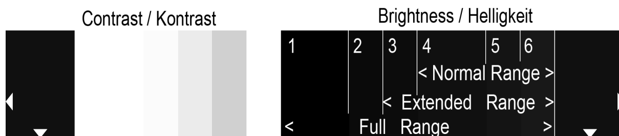
Abbildung 6.2 – Der untere Bildbereich des Testbilds zum Einstellen der Helligkeit. Die Balken 1 - 6 sind für die Abbildung extra hervorgehoben (Trennlinien). Je nach Video Range sehen Sie eine ähnliche oder andere Darstellung. Siehe vorheriges Kapitel. Der darstellbare Video Range entscheidet welche Balken für Sie beim justieren der Helligkeit ausschlaggebend sind.
