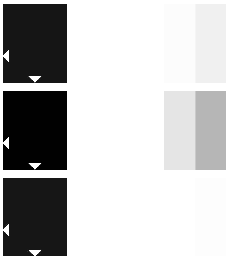
Abbildung 6.3.2.1 – Oben: Hier ist der Kontrast für Extended Range richtig justiert. Der Balken 2 ist minimal heller als der Balken 3 und der Balken 4 ist noch etwas dunkler als der Balken 3. Mitte: Die Balken unterscheiden sich zu deutlich. Der Kontrastwert ist zu niedrig eingestellt. Unten: Die Balken unterscheiden sich nicht oder kaum. Der Kontrastwert ist zu hoch eingestellt.
