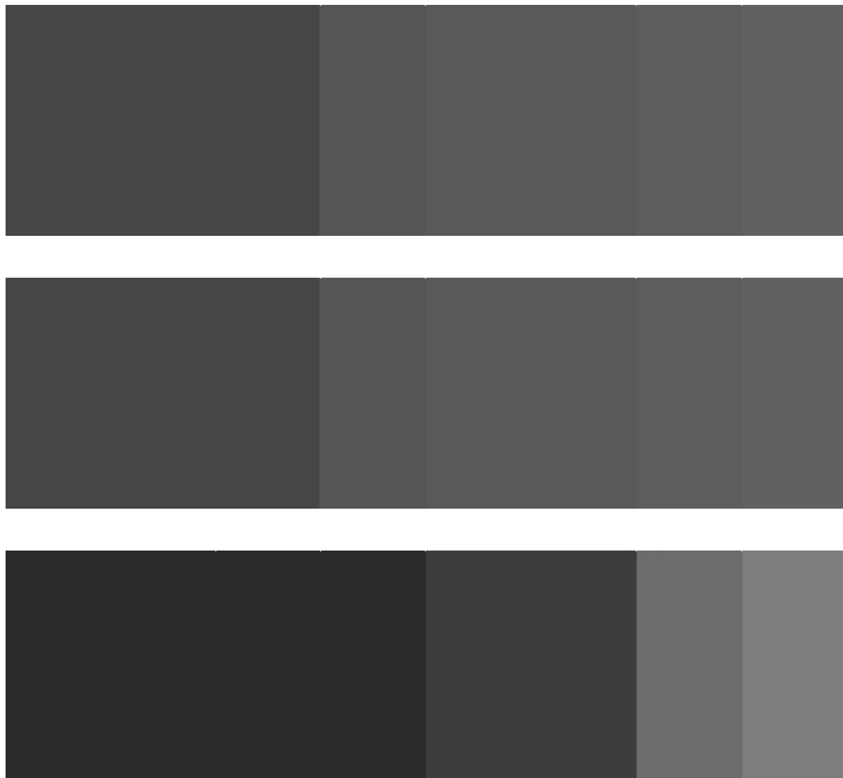
Abbildung 6.1.2.1 – Oben – Full Range. Alle sechs Balken der Grautreppe sind sichtbar. Mitte – Extended Range. Lediglich die Balken 3 - 6 sind sichtbar. Unten – Normal Range. Lediglich die drei rechten Balken sind sichtbar.
