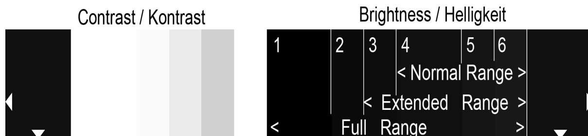
Abbildung 6.2.2.1 – Zum Justieren der Helligkeit bei Extended Range sind die Balken 3 und 4 ausschlaggebend. Bei Full Range muss auf die Balken 1 und 2 zurückgegriffen werden.
