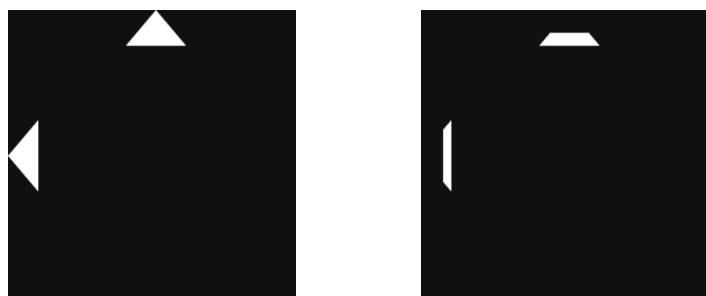
Abbildung 6.5.1 Ausschnitt – Links - richtig eingestellt. Rechts - falsche Einstellung (Overscan aktiviert)
