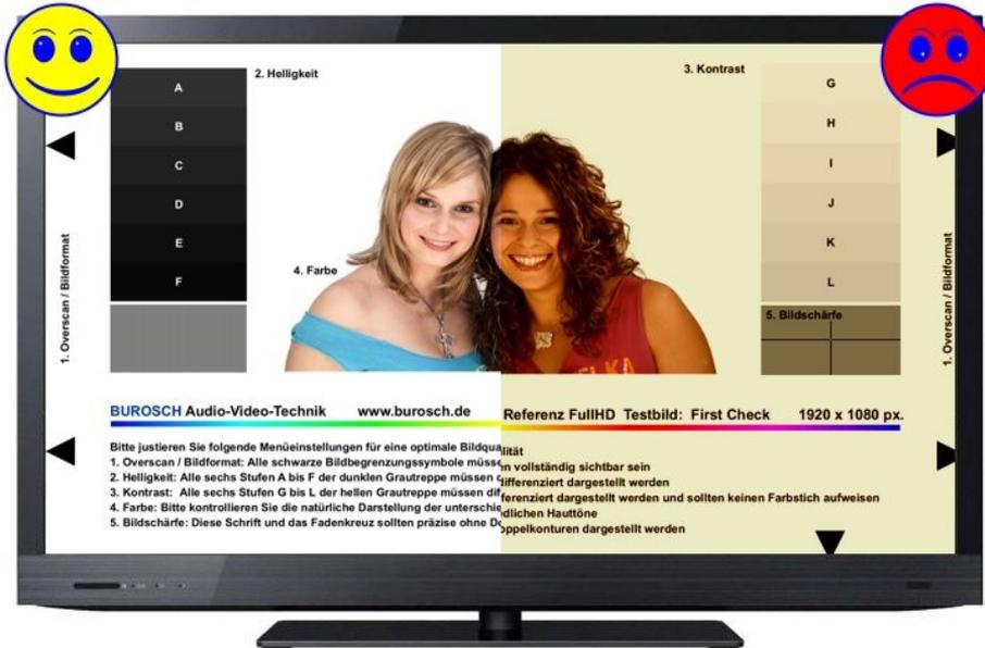
Abbildung 454: Bildvergleich mithilfe des BUROSCH-Testbildes „First Check“
