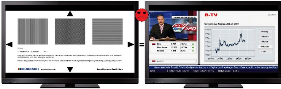
Abbildung 457: Beispiel für falsches Bildformat: schwarze Balken oben und unten sowie Wellenmuster in den Linien-Testzonen.
