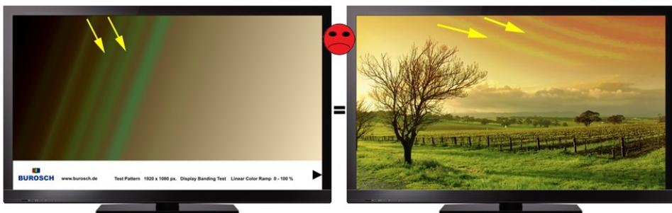
Abbildung 473: Beispiel für Banding-/Clouding-Effekt
