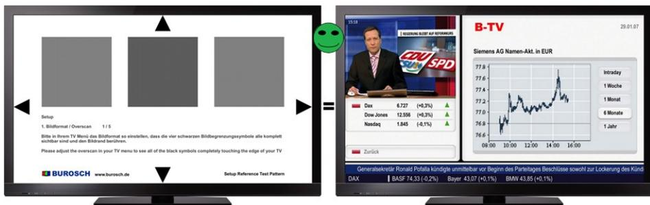
Abbildung 456: BUROSCH Basic-Testbild Nr. 1: Bildformat/Overscan plus Realbild
