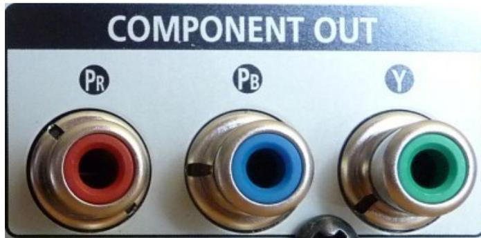
Abbildung 124: YUV-Komponenten-Verbindung
