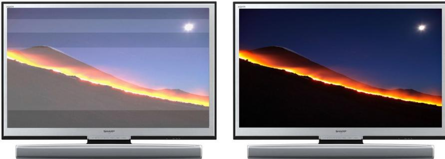
Abbildung 357: CCFL-Technik (links) und LED-RGB-Backlight-Technologie (rechts) im Vergleich (Quelle: Sharp)
