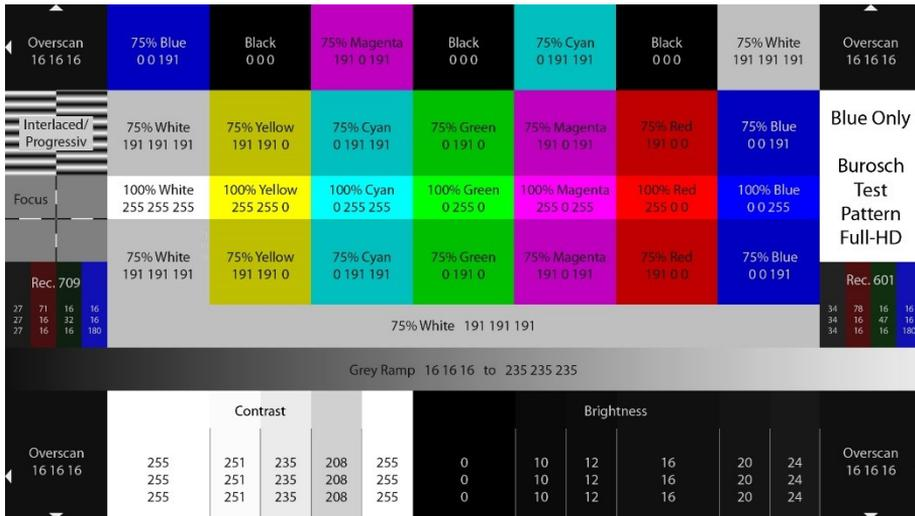
Abbildung 446: BUROSCH Blue-Only Test-Pattern inklusive Erklärung (Wikimedia Commons)
