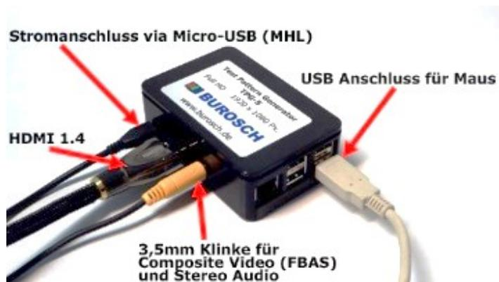
Abbildung 95: Full-HD-Testbildgenerator TPG-5 der Firma BUROSCH
