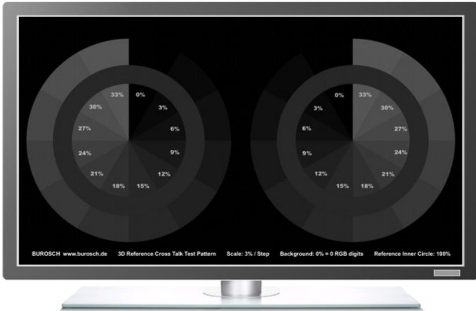
Abbildung 475: Testbild zur Messung des Crosstalk-Wertes
