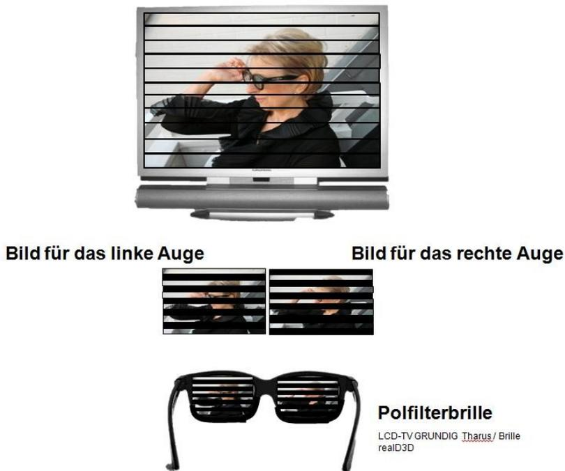
Abbildung 21: Polfilterverfahren (Grundig)
