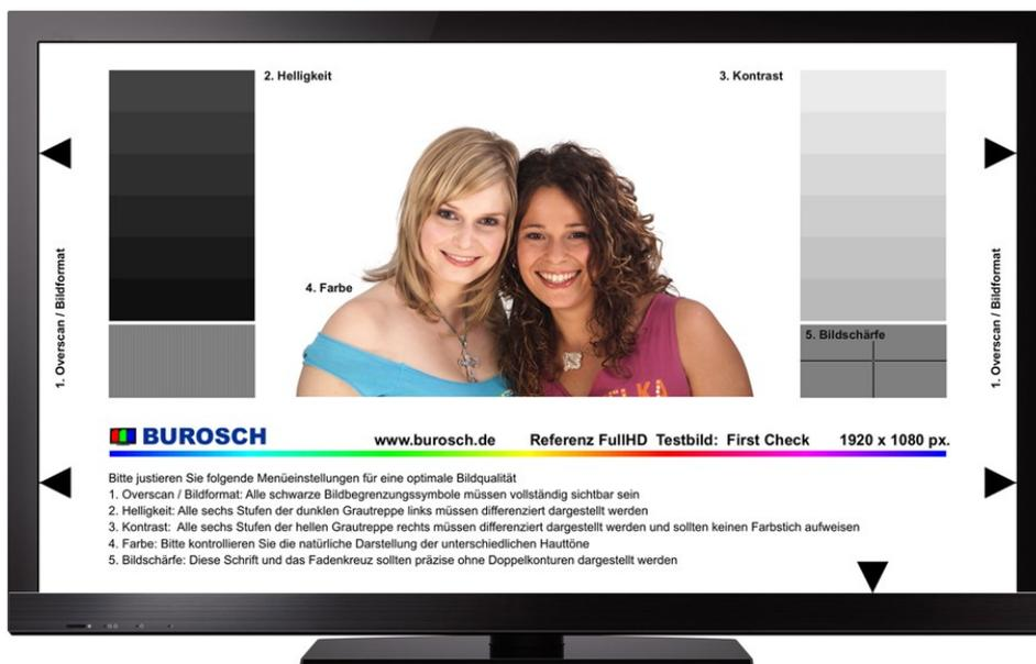
Abbildung 481: Universal-Testbild „First Check“ mit fünf Testzonen
