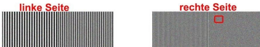
Abbildung 117: Detailansicht des Multiburst-Streifenmusters/hier: „mangelhaft“
