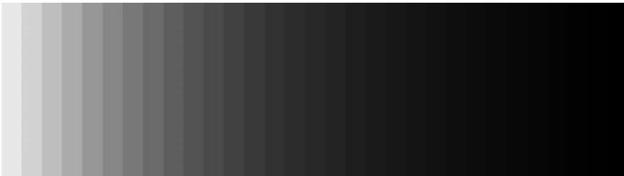
Abbildung 57: Gamma-Korrektur/Gamma zu hoch
